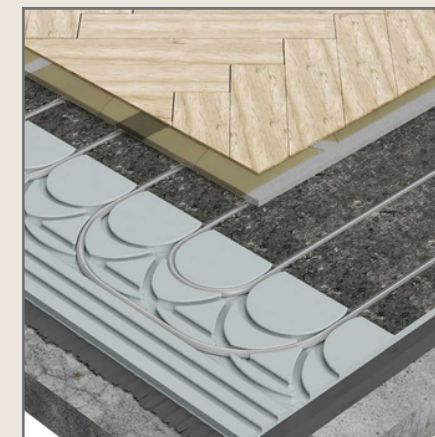
Piso Radiante Hidráulico
