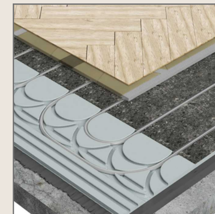
Piso Radiante Hidráulico
